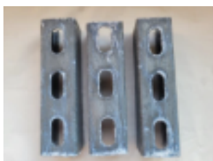
Probetas a 600 horas en NSS
